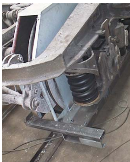
Figuur 6: De kunststof onderlegging ingebouwd (foto NedTrain Consulting)
